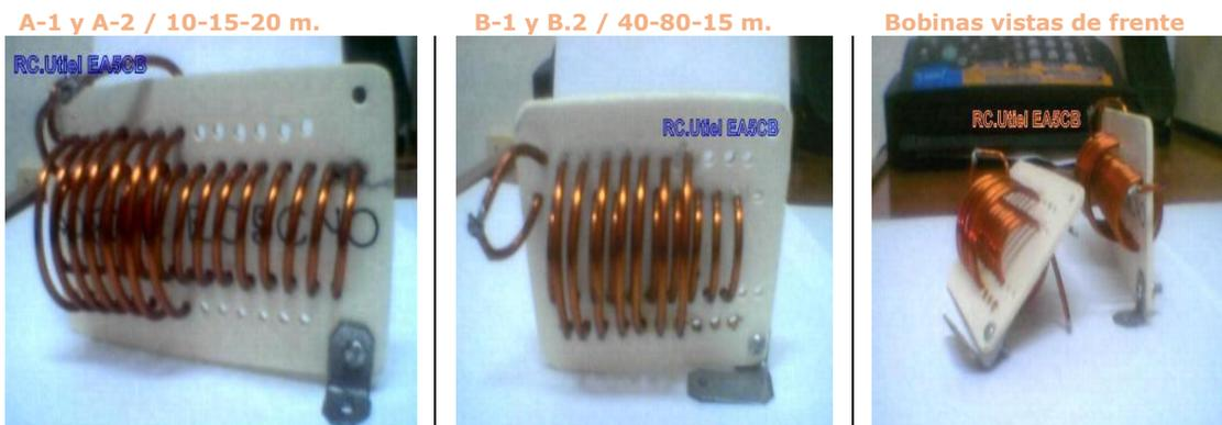
1º hacer las bobinas sobre un tubo y después taladrar 4 filas y enroscar
