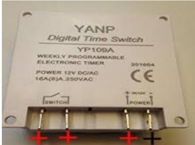
**1º.** La forma de hacerlo son las siguientes: Las marcas de abajo + - no se especifican y hay que tener en cuenta **1º** La conexión de los cables deben colocarse según el esquema de la foto. **2º** La programación de las horas formato digital es sencillo como un reloj digital de pulsera y **3º** Desbloqueo de la unidad para poder configurar, PRETAR cuatro veces seguidas el botón **C/R** el programador los hay a 220vca y 12vcc, las conexiones pueden variar el presente funciona a doce voltios.
